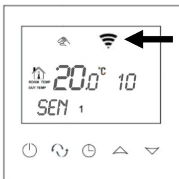
Nach dem Start blinkt das WLAN Symbol auf dem Display.
