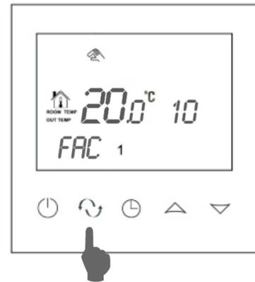
Wechseln Sie mit der Bestätigungstaste (16) bis zum Wert FAC und stellen mit den Pfeiltasten den Wert von 08 auf 10.
